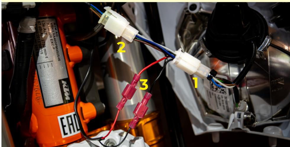
» Busque y desconecte el enchufe de 4 clavijas de la luz (1)
